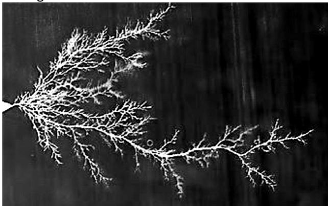
Permanent entstehende Teilentladungen führen je nach örtlicher Gegebenheit innerhalb eines absehba-
