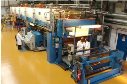
Je nach Anlage können lösemittel- und wasserbasierende Systeme verarbeitet werden. Die maximale Breite beträgt 1,50 m und 1,90 m. Weitere technische Angaben finden Sie unter [www.cmc.de](http://www.cmc.de) Beschichtung.
