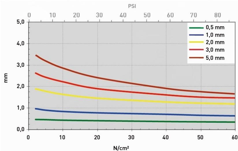
Druckabhängigkeit der Materialstärke bei CMC 15306
