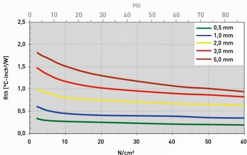
Druckabhängigkeit des thermischen Widerstands  $R_{th}$  bei CMC 15306
