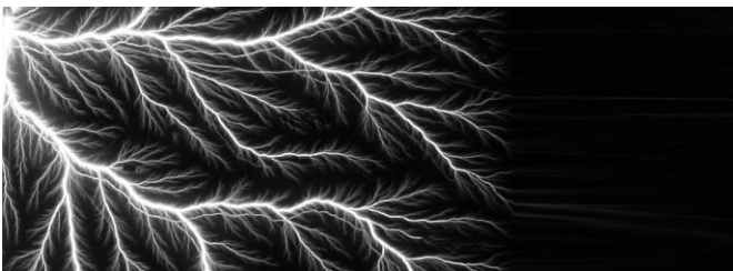
Ausbildung eines leitfähigen Pfades (electrical treeing) auf oder in Isolationsmaterialien (Quelle: CMC)
